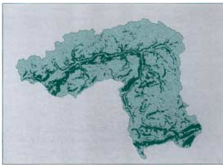
▲ Fig. 3. – Visualisation des zones de pente forte (>7%) sur le bassin-versant de l'Elorn
