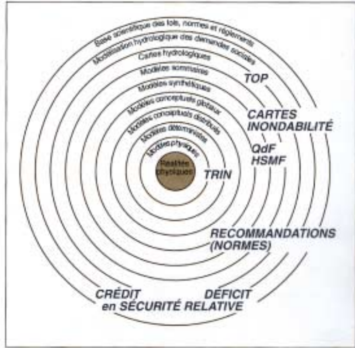
▲ Figure 8. - Choix des niveaux de modélisation, pour les sous-modèles d'INONDABILITE, dans la panoplie disponible en hydrologie (rappel : TRIN = TAL). (d'après G. Oberlin et E. Lama-Desbos)
