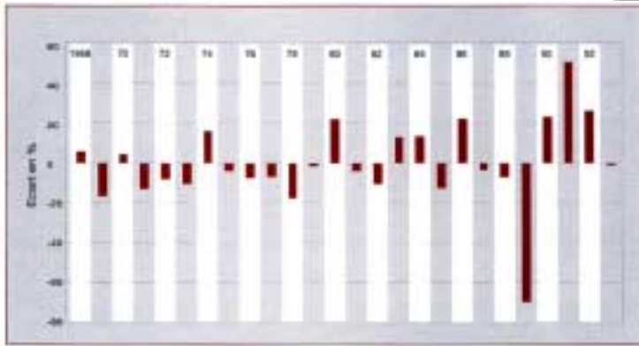
▲ Figure 4. - Ecart relatif entre les écoulements annuels observés et calculés par le modèle mensuel GR2M
