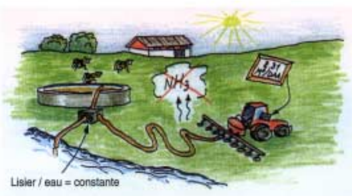
Figure 7. – Système de dilution en ligne pour épandre le lisier sur les prairies. Une unité de contrôle pour mélanger le lisier et l'eau est en cours de développement.
