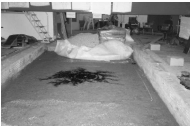
Ainsi, la non uniformité de la transmissivité d'interface, conséquence de la présence de plis et de la non planéité du sol est une des explications possibles du résultat obtenu, mais les artefacts expérimentaux relevés ici ne permettent pas de conclure avec certitude.
