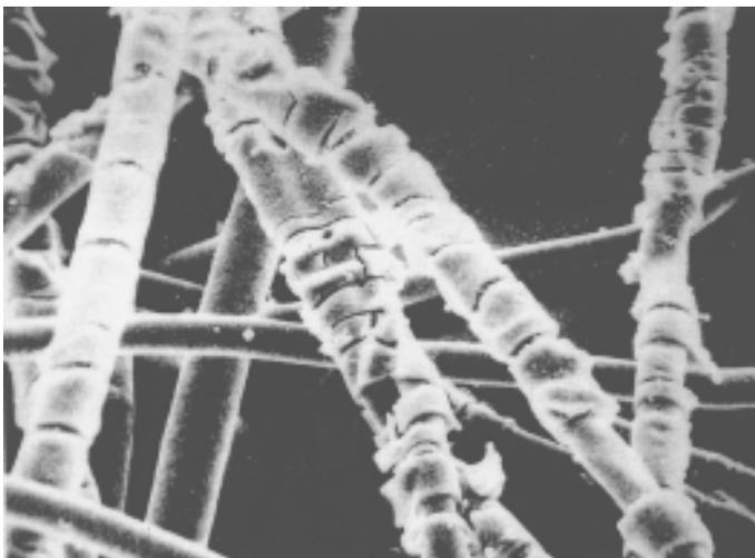
▲ Figure 3. – Fibres synthétiques dégradées par rayonnement ultraviolet.
