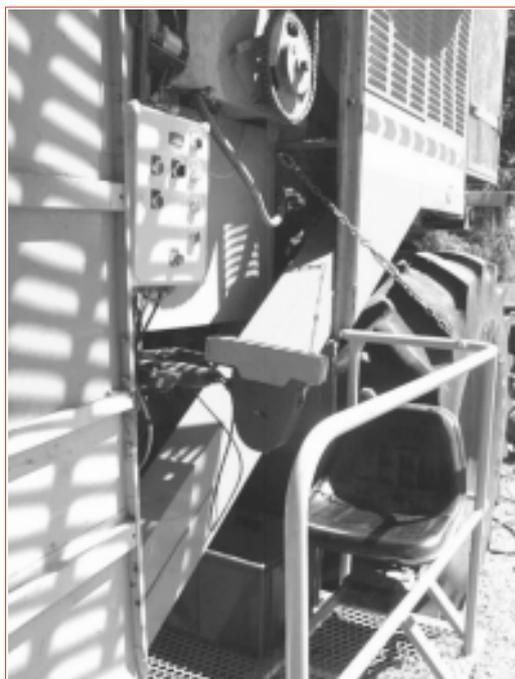
► Photo – Implantation du dispositif de prélèvement et de conditionnement des échantillons sur la moissonneuse-batteuse.
