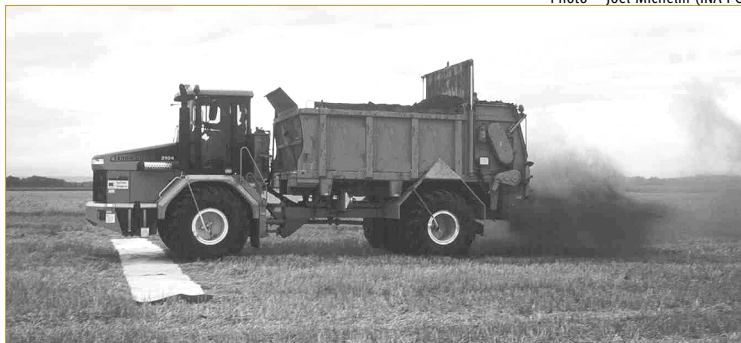
▲ Photo – Chantier d'épandage avec un engin auto-moteur.
