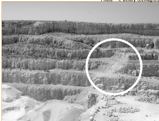
Photo 1 – Préparation d'un front de taille par talutage des banquettes, afin de diminuer l'effet d'escalier du front de taille, d'augmenter l'épaisseur de stériles par endroit, et de créer des micro-expositions favorables.
