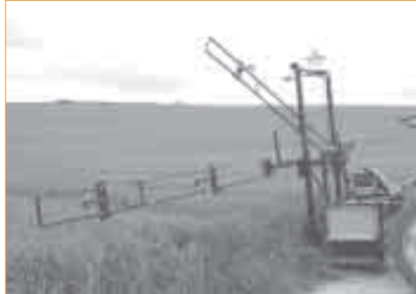
► Photo 1 – Vue de la rampe et du dispositif de mesure de rayonnement.
