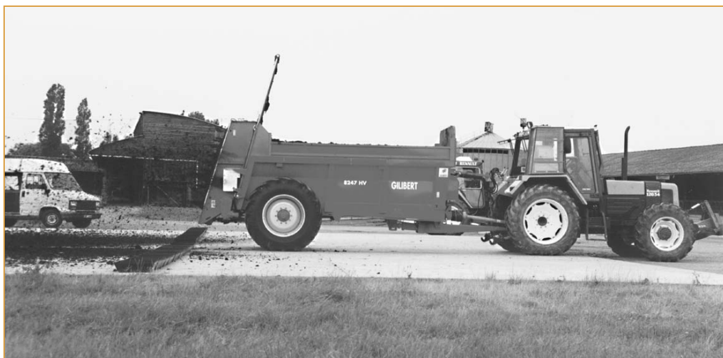
► Photo 3 – Essai de répartition transversale (photo F. Chabot).
