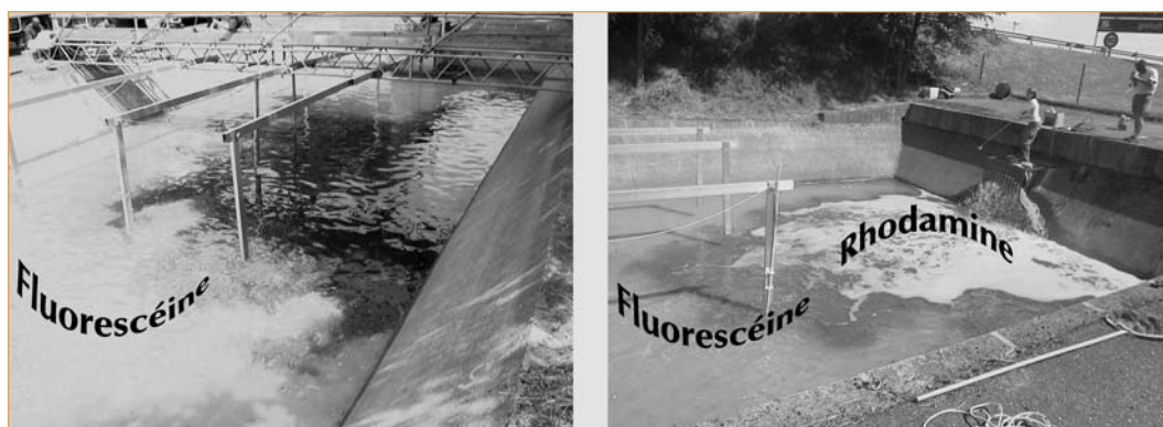
► Photo 6 – Répartition du nuage en surface (A) fluorescéine et (B) rhodamine – Vienne, juillet 2002.
