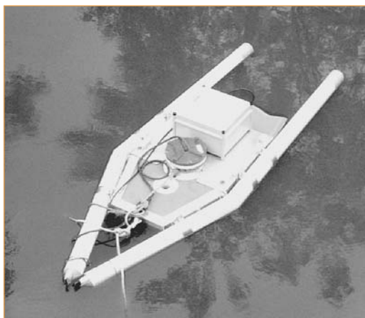
▲ Photo 5 – Premier dispositif de flottaison de l'ADCP de la Diren de Franche-Comté – Vienne, juillet 2002.
