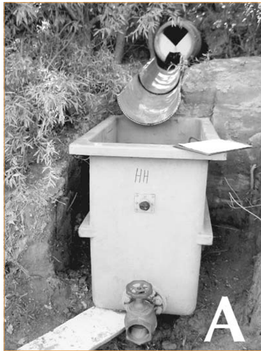
▲ Photo 4 – La mesure de débit au niveau de la canalisation de sortie (A) par capacité et (B) avec le déversoir triangulaire – Bédarrides, mai 2003.
