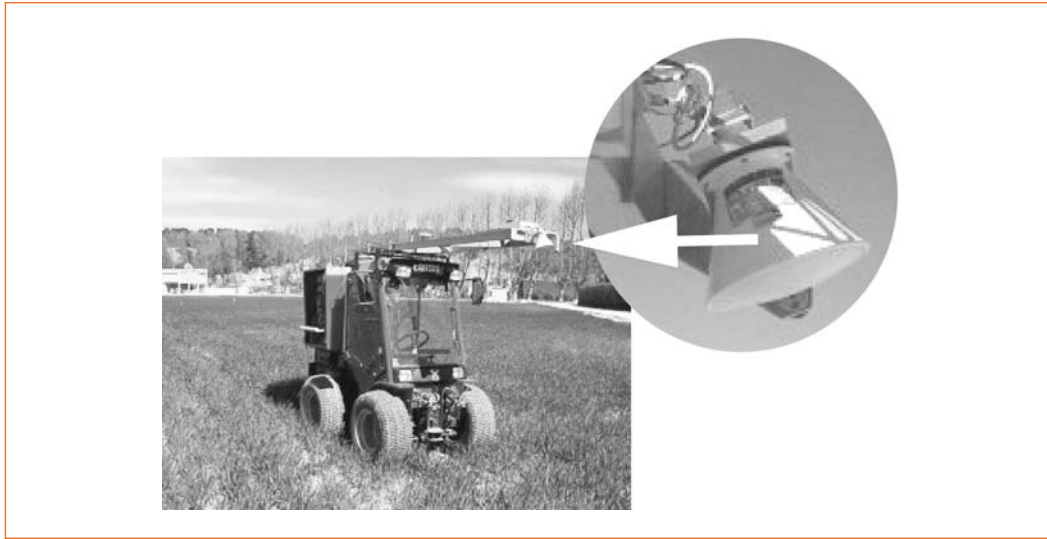
◀ Figure 9 – Implantation du système de mesure hyperfréquence sur un engin mobile. L'antenne du radar se trouve sur un portique à l'avant du véhicule, à une hauteur de 2 m. Le véhicule dispose d'un système de localisation absolu (GPS cinématique Dassault-Sercel) autorisant un positionnement centimétrique.
