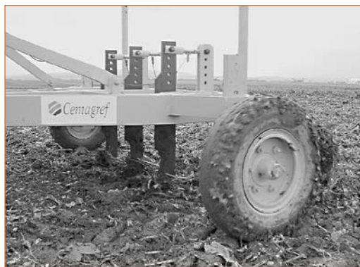
► Figure 14 – Outil de cartographie de dureté du sol (OCDS) développé par le Cemagref.
