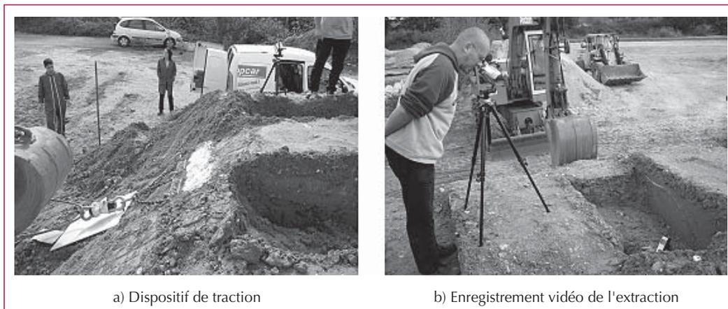
◀ Figure 3 – Instrumentation de l'expérimentation en vraie grandeur.
