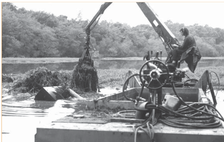
▲ Photo 3 – Arrachage mécanique par une griffe sur ponton dans l'étang du Turc (Landes, 1993).
