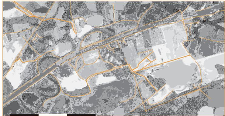
▼ Figure 6 – Exemple de projet de recalibrage généralisé d'un cours d'eau. En blanc : le profil initial ; en gris : le profil à créer (source : DDAF 01).
