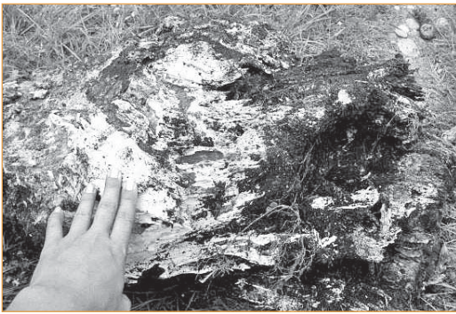
▲ Photo 7 – Traces d'attaques de larves et insectes.
