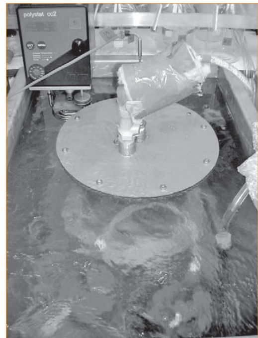
▲ Photo 1 – Cellule respirométrique en inox de 10 l en cours de fonctionnement, dans son bain thermostaté.
