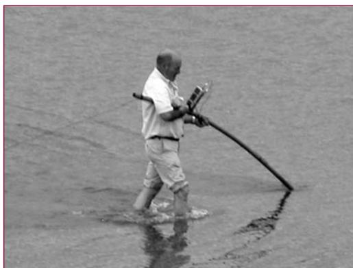
▲ Figure 11 – Détection électrique par dipôle (géomembrane protégée par 0,30 m de gravier). Photo : Documentation Appligeo.
