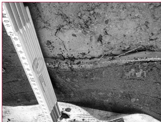
► Photo 6 – Vue de la tranche du GSB après prélèvement et du sol support sur l'ISD B.
