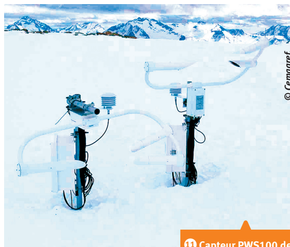
11 Capteur PWS100 de droite en position normale d'utilisation pour mesurer les flux verticaux. Capteur de gauche dédié à la mesure des flux horizontaux venant du nord.
