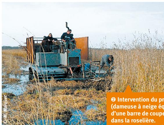
② Intervention du prototype (dameuse à neige équipée d'une barre de coupe) dans la roselière. L'enjeu majeur est de limiter la portance de la machine sur ce substrat tourbeux instable.
