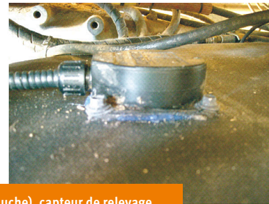
2 Capteur d'attelage (photo de gauche), capteur de relevage (photo centrale), jauge à carburant (photo de droite).
