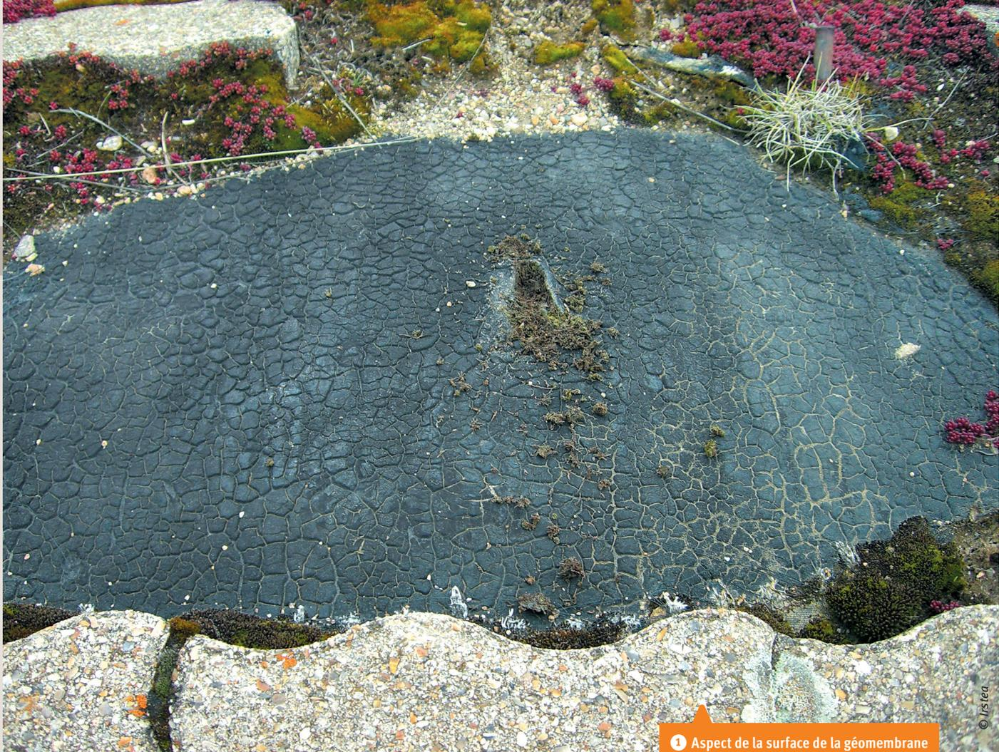
1 Aspect de la surface de la géomembrane du site 5 au moment du prélèvement.
