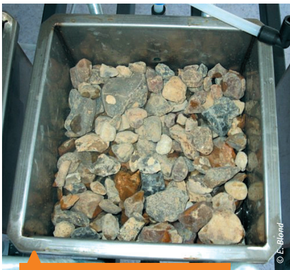
2 Gravier drainant utilisé en référence (dimensions de la cellule : 250 mm x 250 mm).
