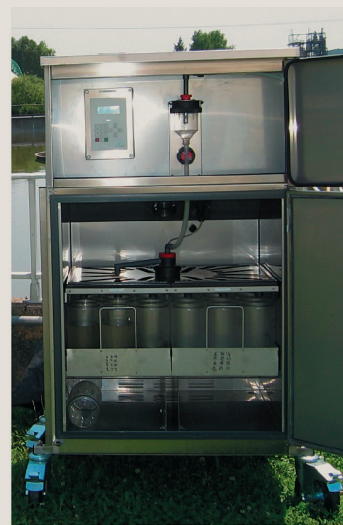
Échantillonneur automatique réfrigéré avec tuyau Téflon et flaconnage en verre
