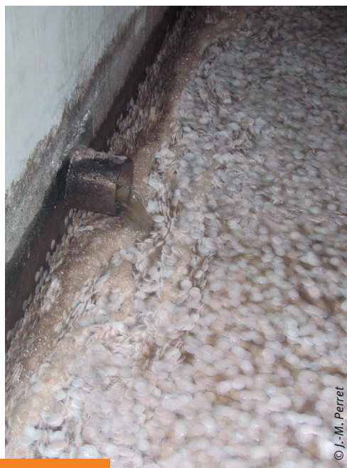
2 Matériau Biochip-M fluidisé dans leur réacteur.
