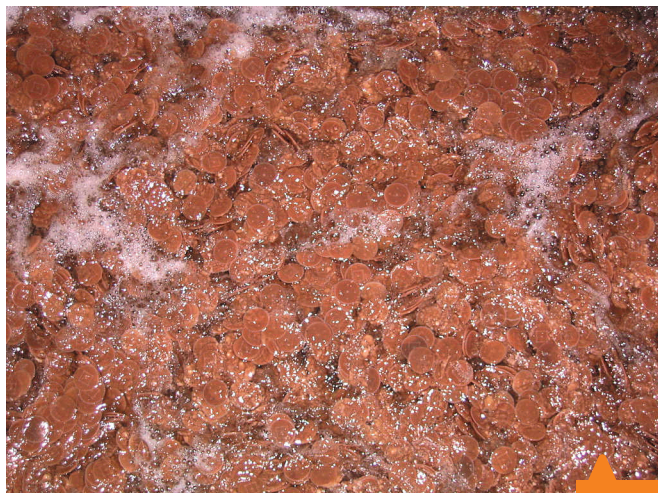
2 Matériau Biochip-M fluidisé dans leur réacteur.
