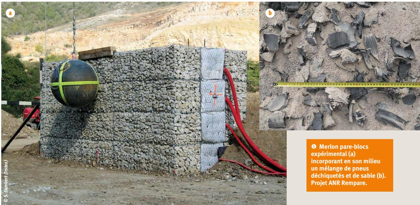
① Merlon pare-blocs expérimental (a) incorporant en son milieu un mélange de pneus déchiquetés et de sable (b). Projet ANR Rempare.
