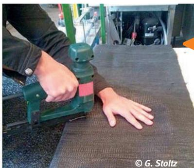
② Réalisation des points de colle au sommet de l'échantillon et fixation par agrafes de la nappe tissée de bandelettes à la planche de bois.
