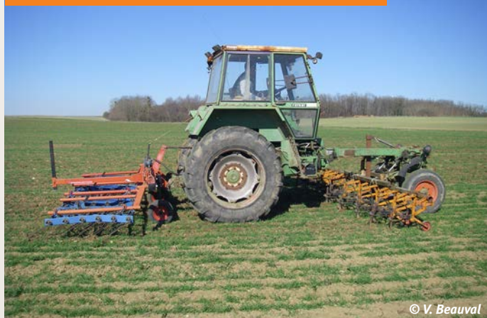
3 Porte-outils équipé d'une bineuse de 4,5 m à l'avant et d'une herse étrille à l'arrière.
