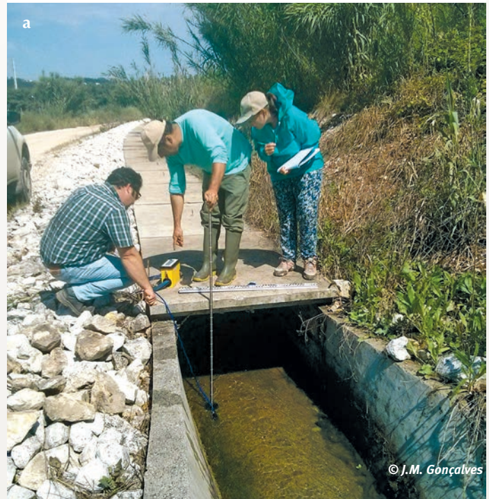
3 Vue des activités de suivi au champ : a) taux de débit du canal avec courantomètre électromagnétique ; b) teneur en humidité du sol avec la méthode TDR.
