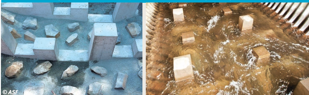
2 Vue détail du dispositif avec la semelle rugueuse et les ralentisseurs préfabriqués (hors d'eau et en eau).
