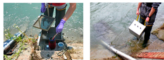
2 Photos du piège à particules lors de son déploiement/retrait et distribution granulométrique d'un échantillon de matière en suspension collecté par piège à particules, par pompage/centrifugation et par prélèvement manuel (d'après Dabrin et al. , 2019).
