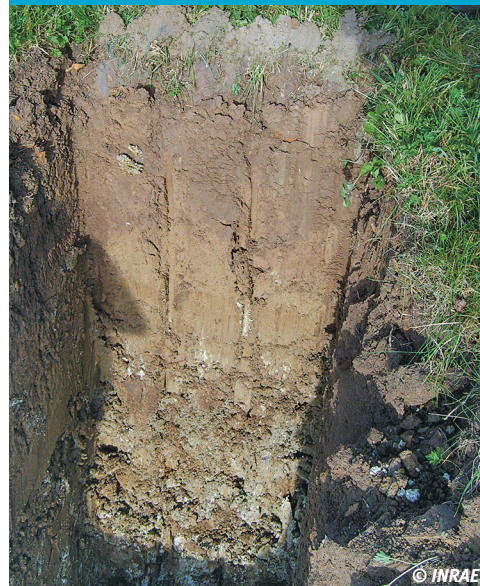
4 Étude géotechnique et pédologique des sols en place avant la construction de la zone tampon humide artificielle (10/09/2007)
