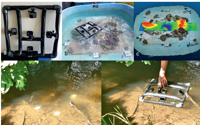
Figure 2 – a) Dispositif amélioré de prises de vues subaquatiques avec cinq caméras et un cadre flottant ; b) Dispositif expérimental en bassin au-dessus d'un habitat artificiel ; c) Analyse de la microtopographie d'un habitat artificiel. Les variations de couleurs traduisent des variations de la hauteur d'eau (Z) au-dessus des éléments (e.g., galets, pierres) du substrat ; d) Positionnement des cibles ou GCP in situ ; e) Déploiement du dispositif in situ .
